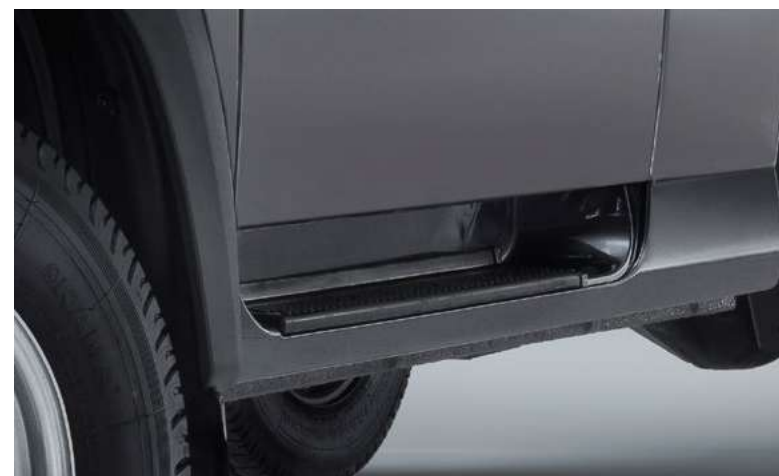
Подножки с противоскользящим покрытием
