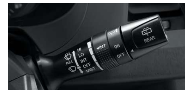
Правый подрулевой переключатель с регулировкой паузы стеклоочистителя
