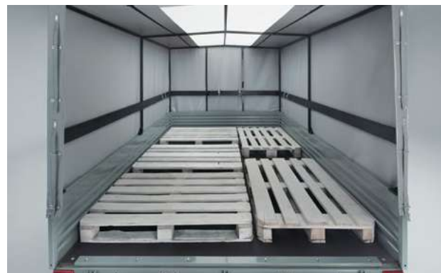
Светопроницаемая крыша. Прочный проклеенный тент
